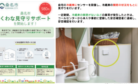
三重県桑名市の高齢者向けICTデバイス活用事例。冷蔵庫の開閉状況により見守りサポートを実施。プライバシーにも配慮した仕組みになっている。
